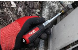
Extractor de Núcleo de Válvula Schrader®
