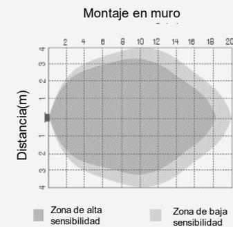
**Funciona a través de la detección de diferencias de calor**
