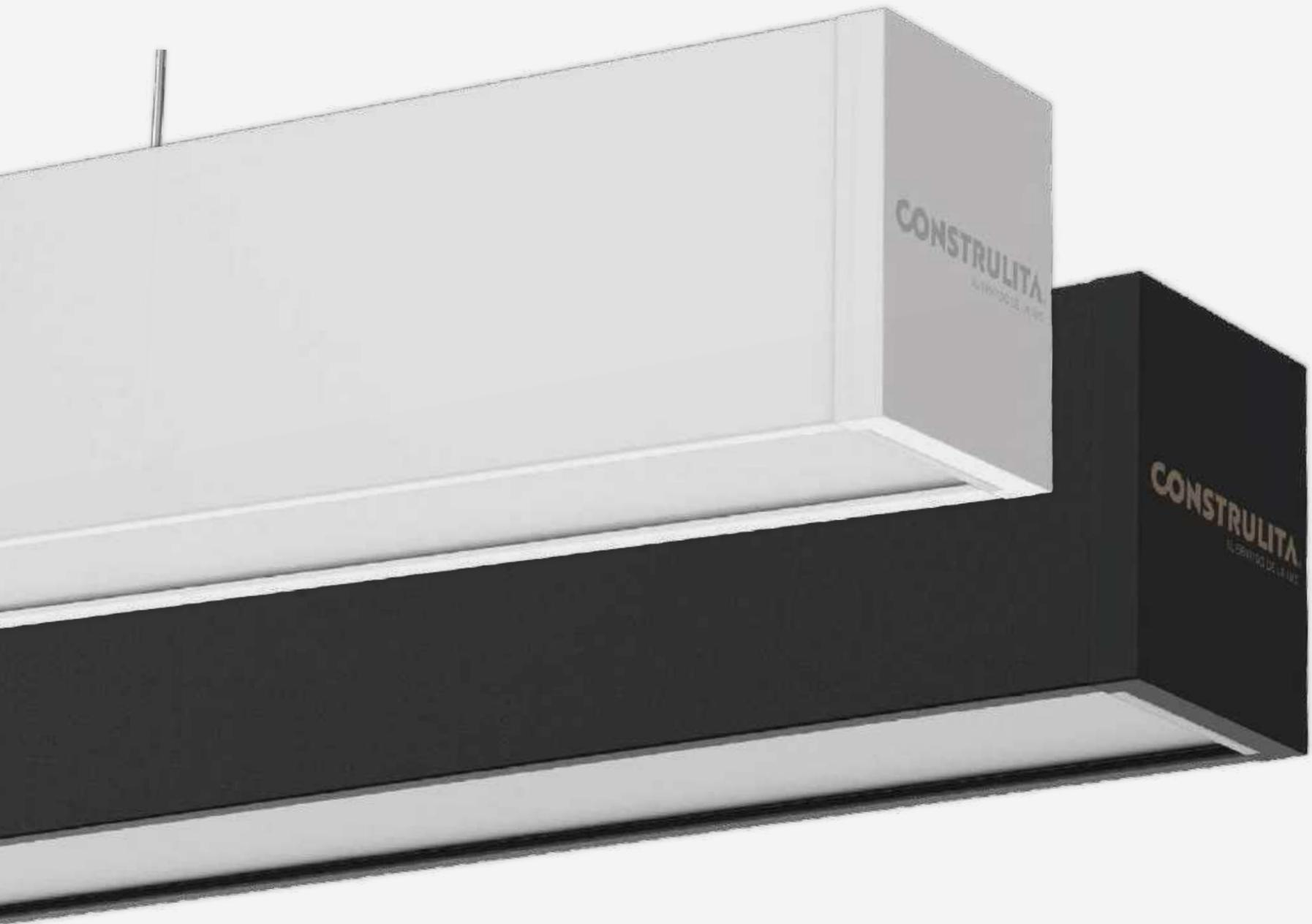
Sistema de iluminación lineal habilitado para empotrar, sobreponer o suspender; con posibilidad de atenuación 0-10V o luminarios On/ Off, módulos con interconexión mecánica y eléctrica mediante exclusivo sistema de unión macho-hembra y sus clips para cierre eléctrico formando líneas continuas en segundos.
