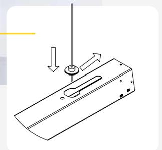
Ranura para desplazamiento en caso de obstrucciones en la losa o plafón.
